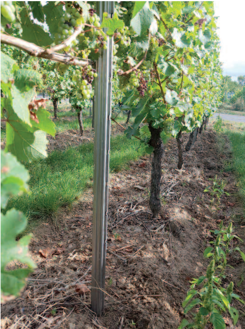
Bild 3: Weinbergstickel aus Edelstahl Rostfrei, 20 Jahre freibewittert, Werkstoff: 1.4003 (Foto: Gaubatz, Hochschule Geisenheim University, Geisenheim)
